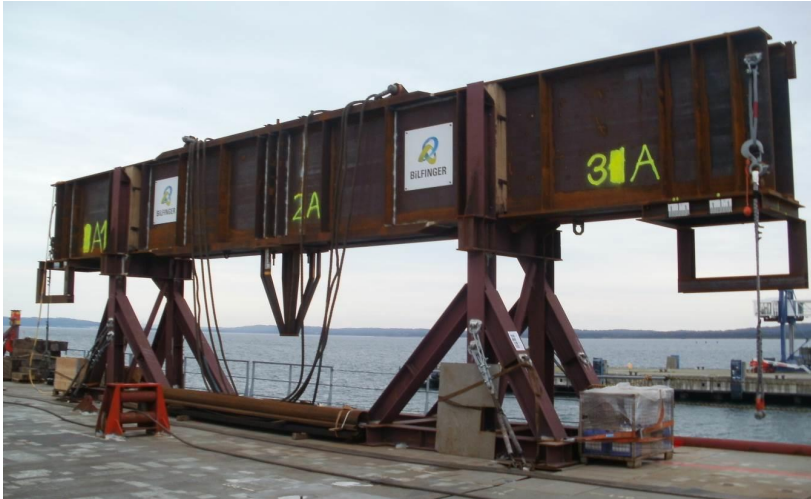
Abbildung 7: Lasttraverse während der Installationsphase
