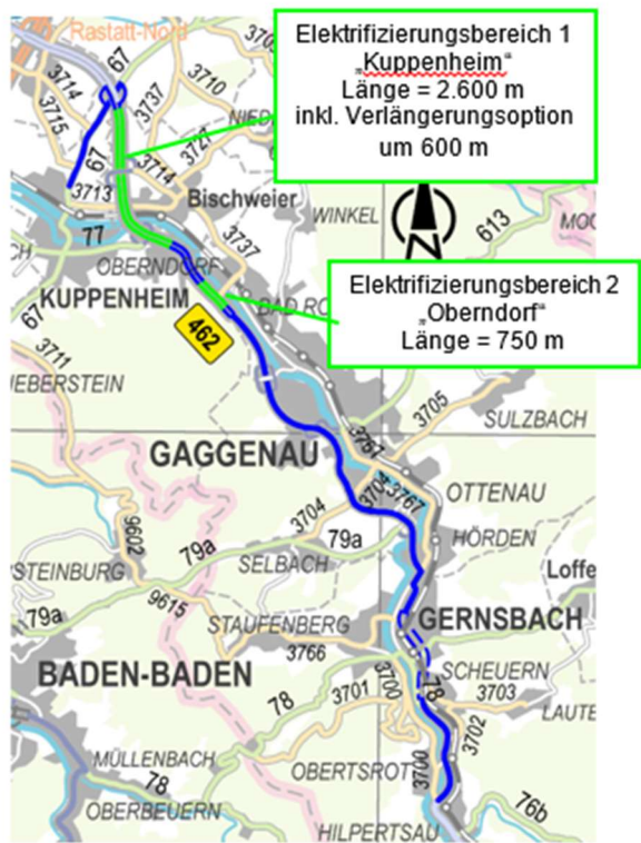
Abbildung 2: Oberleitungsstrecke des Pilotprojekts eWayBW [2]
