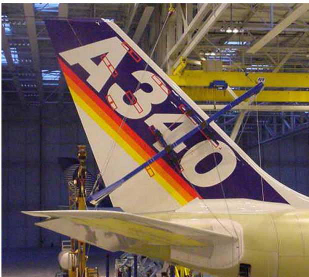
Abb. 2.4. Kalibrierung einer Seitenleitwerksstruktur, [3].
