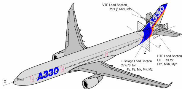
Abb. 2.1. Lastebenen-Definition am Flugzeugheck, [3].
