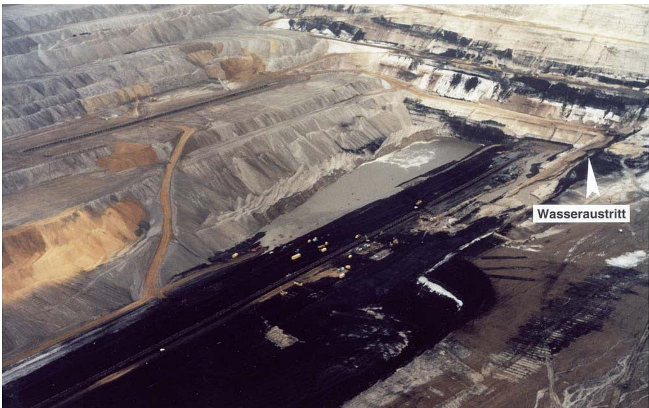
Abb. 1 Tagebau Hambach mit Gewinnungs- und Verkippungsseite sowie dem Grundwasser-See (aufgenommen im Dezember 1997)
