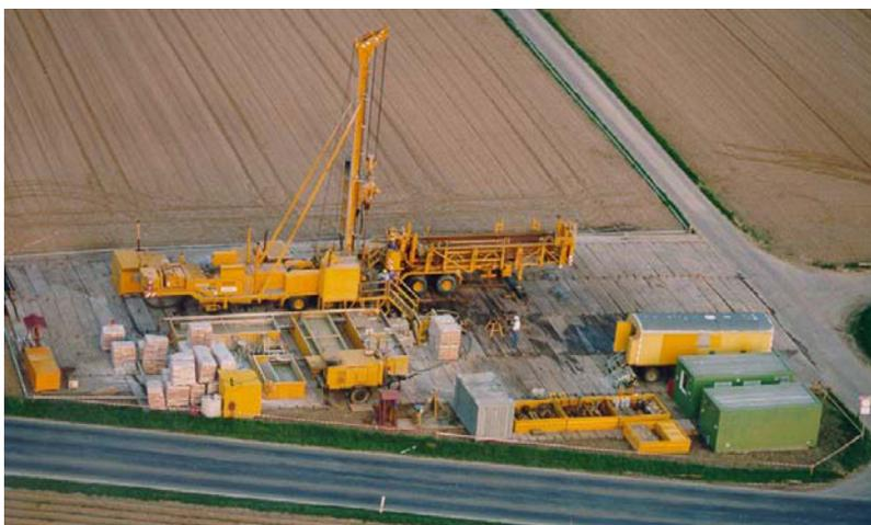
eine B 4A der Fa. WIRTH mit einer Hakenlast von 600 kN. Das verwendete Bohrgestänge ist ein 6“ Vorschweißgestänge, welches im Bohrtrieb üblicherweise zum Seilkernen eingesetzt wird. Eine theoretische Endteufe von 1 285 m ist in dieser Bohrerät/Bohrgestängekombination möglich. Die hier aufgeführte Spülpumpe der Fa. GEHO ist die Standardpumpe des Bohrbetriebs.
