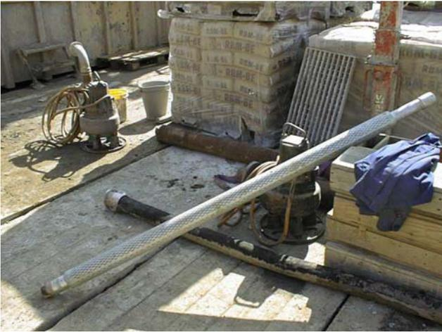
Abb. 7 Kiesklebefilter Hagulit
