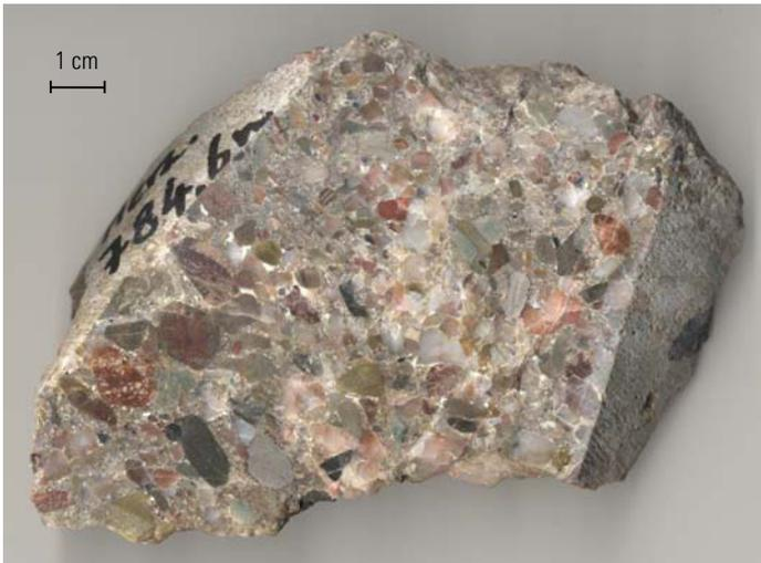
Abb. 6 Polymiktes Konglomerat, Unterdevon, Bohrung Merzenich, Teufe 784,6 m
