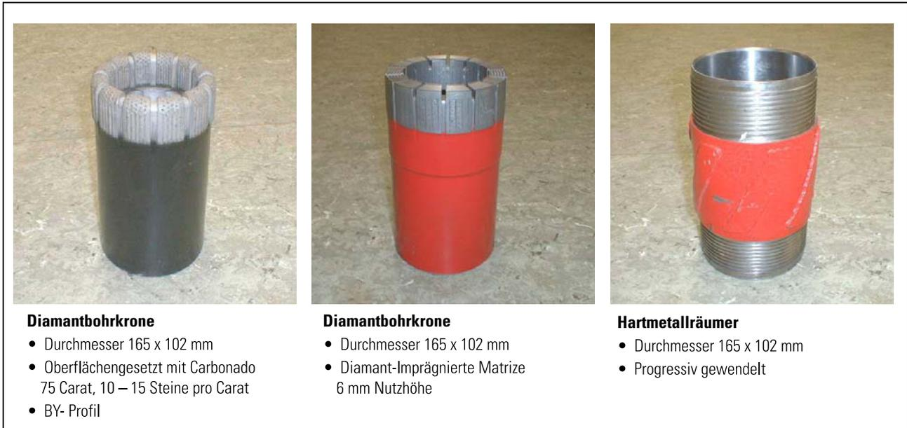
Abb. 15 Sonderanfertigung Diamantbohrkronen und Hartmetallräumer
