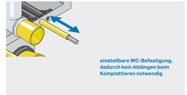
einstellbare WC-Befestigung, dadurch kein Ablängen beim Komplettieren notwendig
