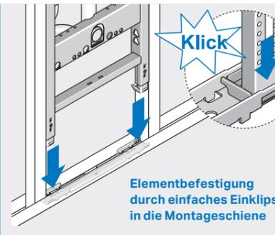
Elementbefestigung durch einfaches Einklippen in die Montageschiene
