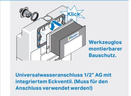
Universalwasseranschluss 1/2" AG mit integriertem Eckventil. (Muss für den Anschluss verwendet werden!)
