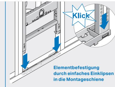
Elementbefestigung durch einfaches Einklippen in die Montageschiene
