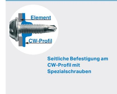
Seitliche Befestigung am CW-Profil mit Spezialschrauben
