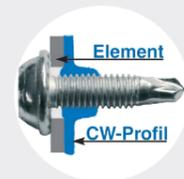
Seitliche Befestigung am CW-Profil mit Spezialschrauben
