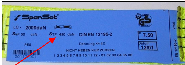
Abb. 3: STF = 450 daN gibt die Vorspannkraft an, die mit dem Spannelement bei normaler Handkraft in das Zurrmittel eingebracht werden kann.
