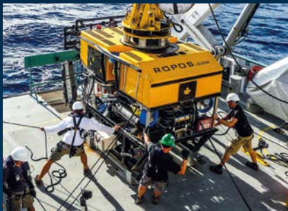
▲ Ausbringen des ROV ROPOS von Bord der FALKOR. Foto: Schmidt Ocean Institute / CSSF
