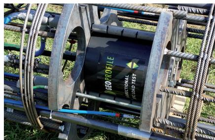
Alternativ kann der Versuch **bi-direktional** ausgeführt werden. Wesentliche Merkmale einer bi-direktionalen Ausführung sind die separate und unabhängige Messung des Spitzenwiderstandes und der Mantelreibung entlang dem Pfahlschaft, und das Entfallen einer separaten Reaktionsvorkehrung. Dazu wird in den zu prüfenden Pfahl eine Hochlastzelle eingebaut. Anschliessend
