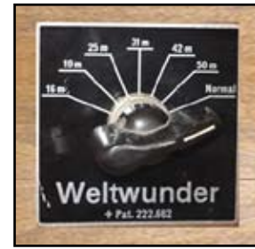
Rex Medium II mit Kurzwellenadapter «Weltwunder» 16 - 19 - 25 - 31 - 42 und 50 m-Band
