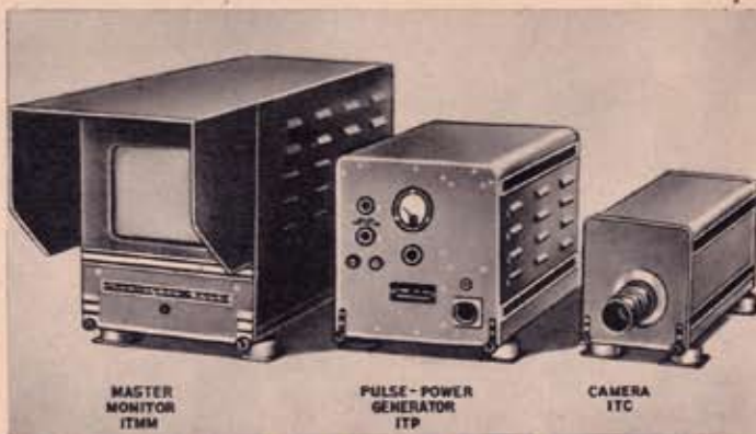
Das System besteht aus diesen 3 Teilen, die durch Kabel verbunden sind
