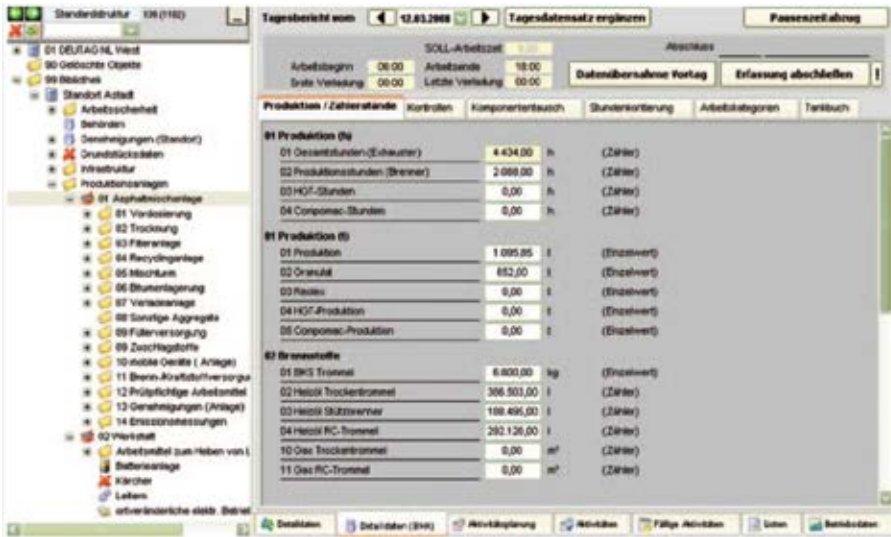
Modul Betriebstagebuch: Erfassungsmaske für Produktionsdaten und Energieverbräuche einer Asphaltmischanlage
