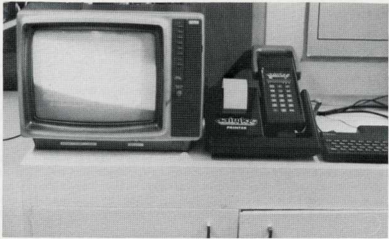
Übersicht 6. Handcomputer zur Erfassung der Milchmengen
