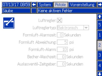
**Luftregler:** Dieses Kästchen aktivieren, wenn das System einen der ProBell Luftregler verwendet.
