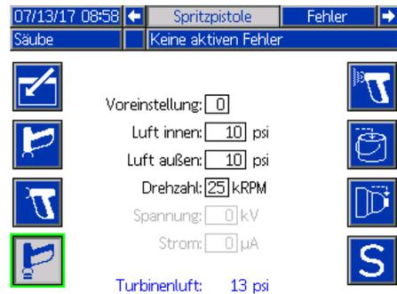
HINWEIS: Unter Voreinstellung 0 können Formluft innen, Formluft außen, Drehzahl, Spannung und Strom über den Bildschirm Spritzpistole geändert werden. Unter Voreinstellungen 1-98 können Parameter vorab in den **Voreinstellungsbildschirmen, Seite Seite 17** eingerichtet werden.
