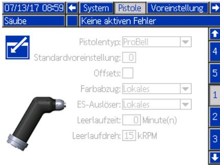
**Pistolentyp:** Art der Pistole auswählen, die im System verwendet werden soll. Die Auswahl des Applikator Typs konfiguriert die Systemregler vor.
