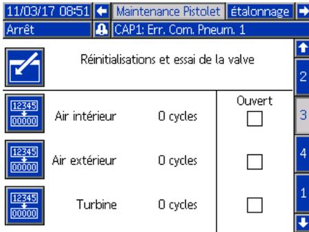
In diesem Bildschirm werden die Zyklusähler der Magnetventile für die Formluft innen und außen angezeigt und zurückgesetzt (in einem Luftregler). Um den Zyklusähler zurückzusetzen, den entsprechenden Softkey fünf Sekunden lang gedrückt halten. Im Pistole Aus Modus können diese Magnetventile zur Funktionsprüfung angesteuert werden.
