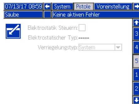
**Elektrostatikregelung:** Dieses Kästchen aktivieren, um alle Einstellungen und Änderungen der Elektrostatik in den Bildschirmen des System-Logikreglers und nicht in den Bildschirmen des Elektrostatikreglers vorzunehmen.
