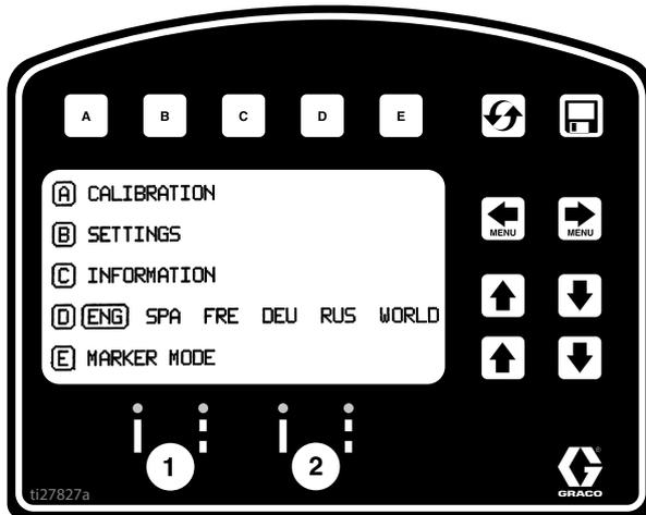
4. Für Kalibrierung **A** drücken. TRAVEL DIST (Fahrstrecke) auf mindestens 7,6 m (25 Fuß) einstellen. Längere Strecken bewirken eine höhere Genauigkeit (in Abhängigkeit von den Bedingungen).
