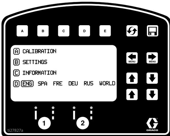
4. **[A]** zur Kalibrierung drücken. TRAVEL DIST (Fahrstrecke) auf mindestens 7,6 m (25 Fuß) einstellen. Längere Strecken bewirken eine höhere Genauigkeit (in Abhängigkeit von den Bedingungen).
