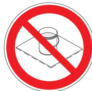
**Metalleimer müssen immer geerdet werden:** Einen Erdungsleiter am Eimer anbringen. Ein Ende am Eimer und das andere Ende an eine effektive Erdung wie z. B. ein Wasserrohr anbringen.
