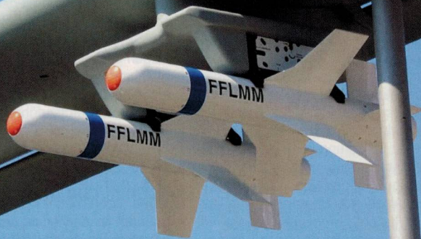
Die Integration von hoch miniaturisierter Präzisionsabwurfmunition an unbemannte Luftfahrzeuge hat begonnen. Das Integrationsbeispiel zeigt das Fee-Fall Lightweight Multi-role Missile (FFLMM) an einem Watchkeeper UAV. (Foto: THALES)
