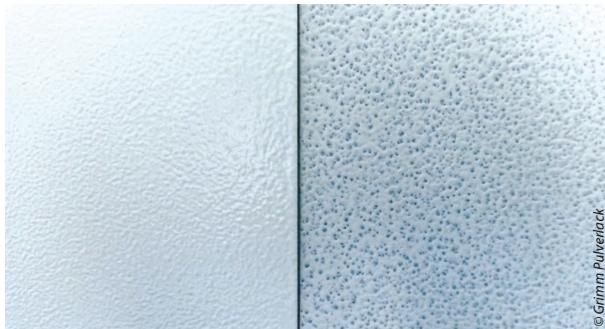
Geringe Schichtdicken, zum Beispiel in schwierig zu beschichtenden Bereichen, führen bei Standard-Strukturpulvern häufig zu Pulverkratern (rechts). Mit dem neuen Strukturpulver (links) konnte dieses Problem bei gleicher Schichtdicke (30 µm) behoben werden.
