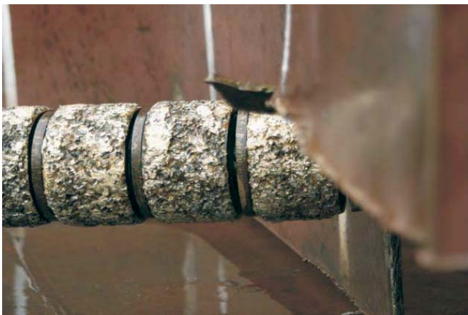
Kettenglieder mit schneidfähiger Oberfläche
