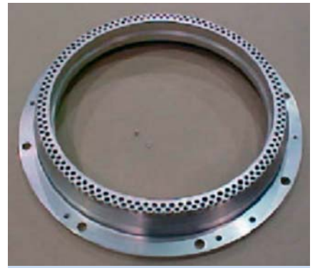
Bild 7. Stahlring aus nicht rostendem Stahl, beschichtet mit Kupfer durch Kaltgasspritzen.
