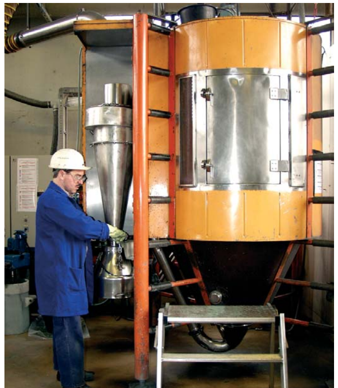
Bild 2: Sprühtrockner Helmut Heise aus dem Amperit-Betrieb in Goslar bedient den Sprühtrockner
