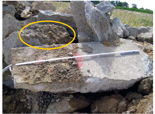
Bild 3: Anhaftende, nachhydratisierte Schottertragschicht aus RC-Material
