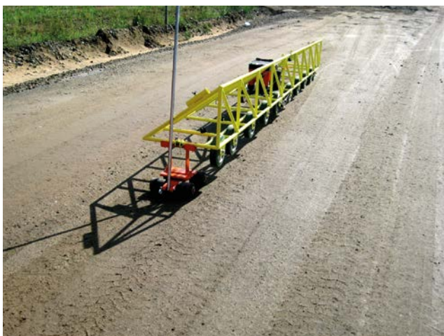
Bild 13: Ebenheitsmessung mit Planograf auf Schottertragschicht
