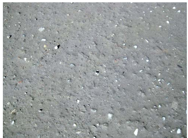
Bild 14: Zu raue Oberfläche für Messung mit Planograf
