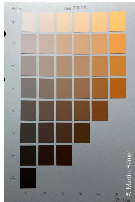
Exemplarisches Beispiel der Munsellfarbtafel zur Bestimmung der Bodenfarbe.
