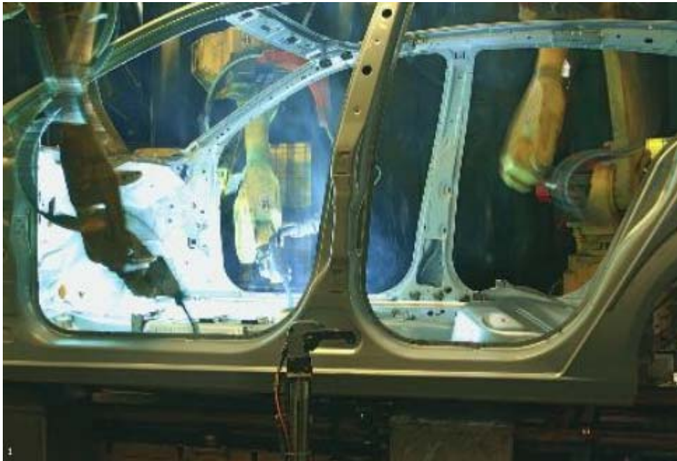
Lichtbogenlöten als Alternative zum Schweißen im Karosseriebau
