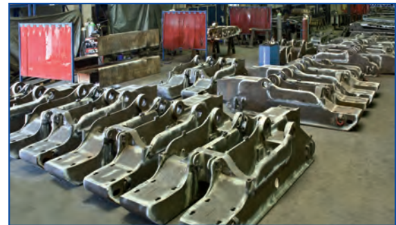
Aufarbeitung von Ausbauschilden
