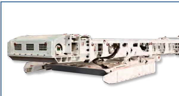
Bandüberföhrung in abgesenktem Zustand
