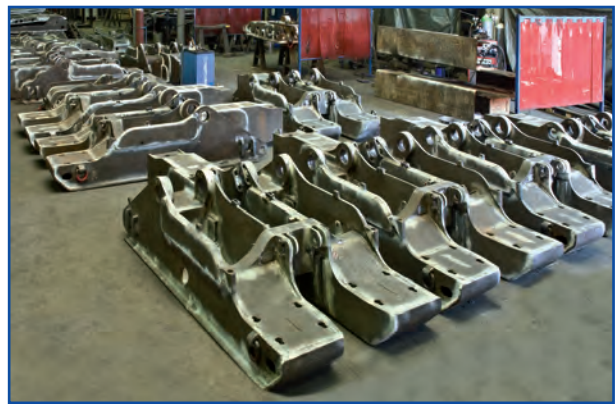
Aufarbeitung von Ausbauschilden
