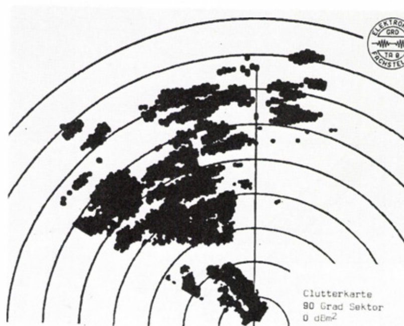
Figur 25: Clutterkarte mit Clutterintensitäten grösser als 0\text{dBm}^2 (= 1\text{ m}^2) (Sektor von 90^\circ ). Das bedeutet, dass in allen dunklen Gebieten die Reflexionsamplituden von Standzeichen grösser sind als diejenigen eines typischen Kampfflugzeuges.
