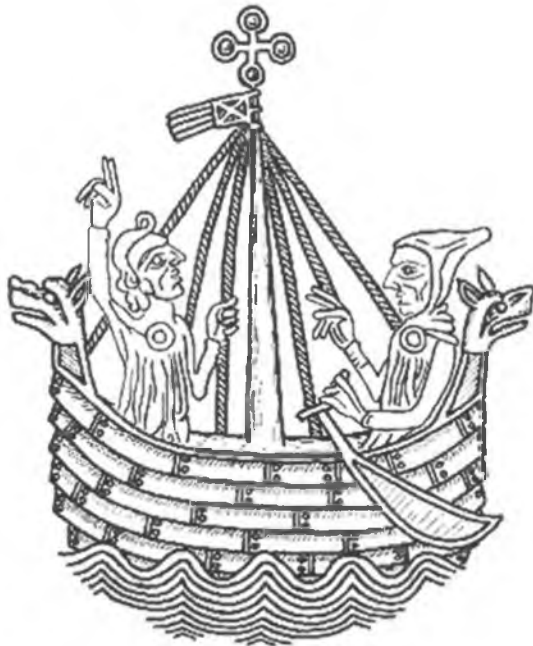
Abb. 8: Schiffsbild des Lübecker Siegels von 1256, Kogge mit Seitenruder und gebogenem Vorsteven, den die Planken überlappen wie auf Abb. 5. Nach Wiechell.
