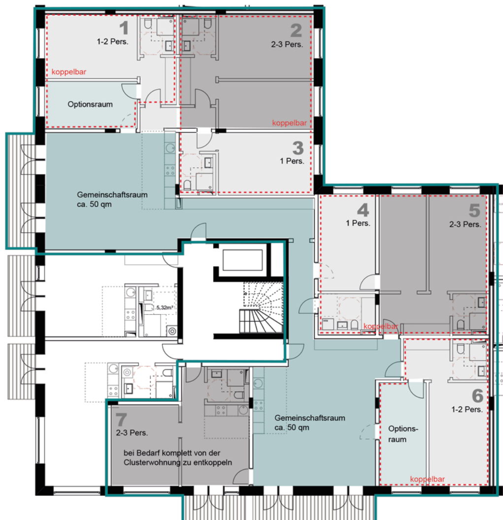
Der Grundriss aus dem Projekt Rathenower Straße zeigt, wie bei Clusterwohnungen die Prinzipien der Flexibilität und Nachnutzbarkeit durch die Verwendung von Optionsräumen sowie die Zuordnung beziehungsweise Entkopplung einzelner Wohnungen und Räume praktisch umgesetzt werden kann
