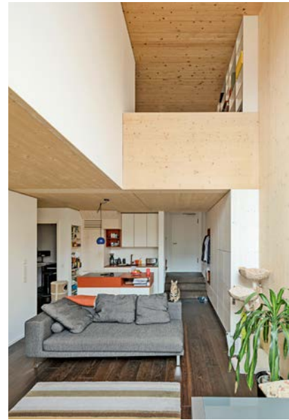
Die Maisonette-Wohnungen im Erdgeschoss des Holzbaus verfügen über 5,60 m hohe Decken
