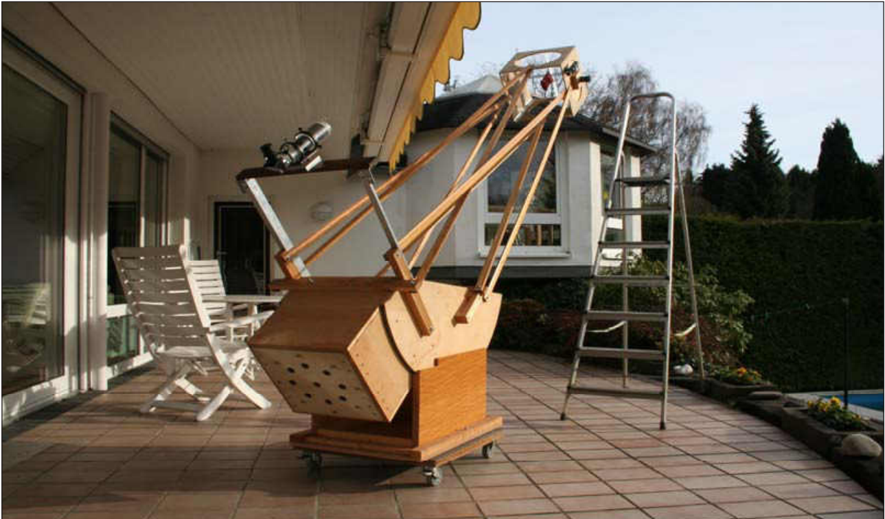
Bild 20: Newton-Teleskop als Holz-Bastelararbeit in „Dobson“-Bauweise, Brennweite drei Meter, Spiegeldurchmesser 30 cm
