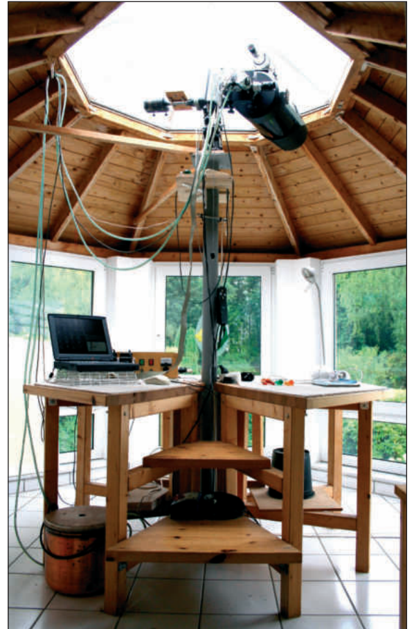
Bild 3: Blick in die Sternwarte. Die Beobachtungen und Justierungen des Teleskops erfolgen von einem begehbaren Tisch aus, der gleichzeitig aber auch als Arbeitsfläche und Stellfläche für den Rechner, die Stromversorgung der Kamera und sonstige Zusatzgeräte dient.
