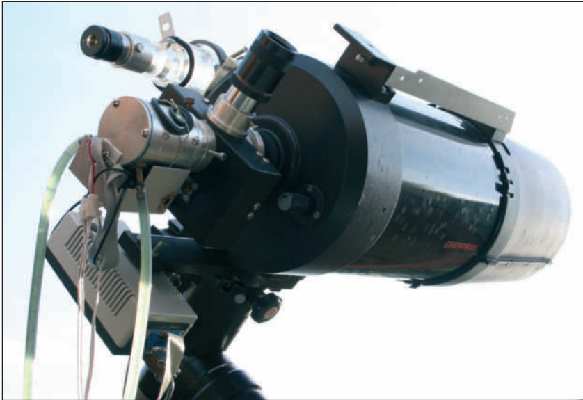
Bild 2a: Das Teleskop C8 mit Eigenbau-Kamera (Beschreibung folgt), mit Klappspiegel, Sucherfernrohr sowie Kabelführungen und Kühlwasserschläuchen zur Kühlung der Kamera.
