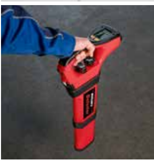
Ortung eines Kamerakopfes mit ROLLER'S Detector (Zubehör)
