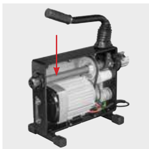
Durchgehende, ungeteilte Antriebsspindel!
