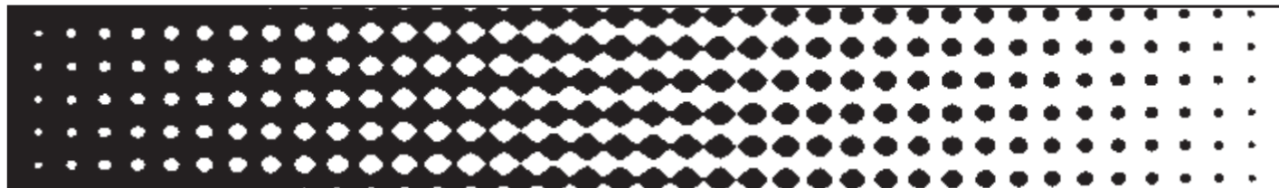
Abbildung 40: Punktform: Smooth Elliptical Rasterfeinheit: 2 l/cm.
