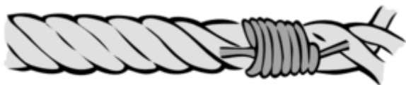
Zum Schluss sollte man überprüfen, ob der Takling fest sitzt und dann beide Enden des Bindegarns kurz abschneiden.
