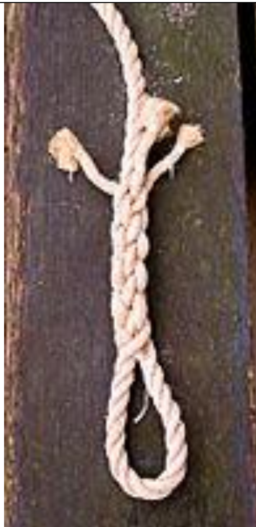
Augspleiß fertig (überstehenden Kardeelen werden noch abgeschnitten)
