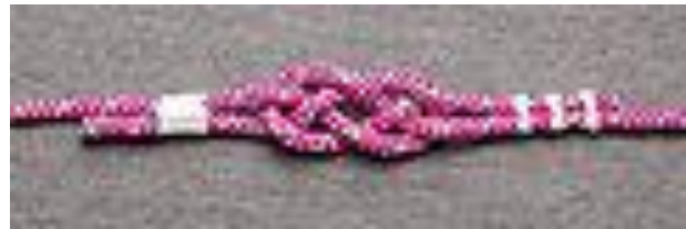
Trossenstek mit Takling gesichert
