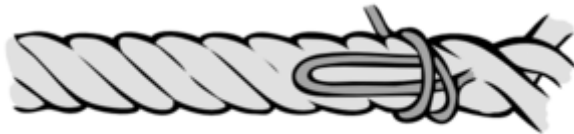
Das Seil fest umwickeln. Die Wicklung sollte ungefähr genauso breit sein, wie die die Dicke des Seiles
