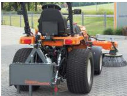
bema PowerPack - Hydraulisches Antriebsaggregat
