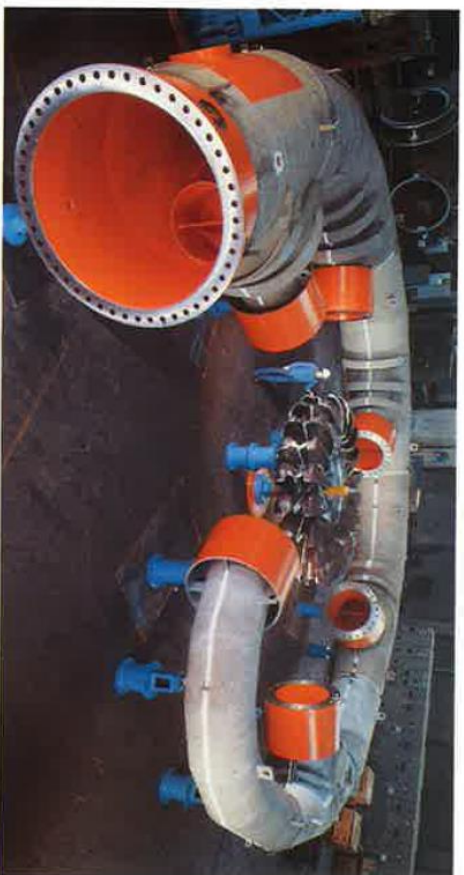
Verteilrohrleitung in der Werkstatt
