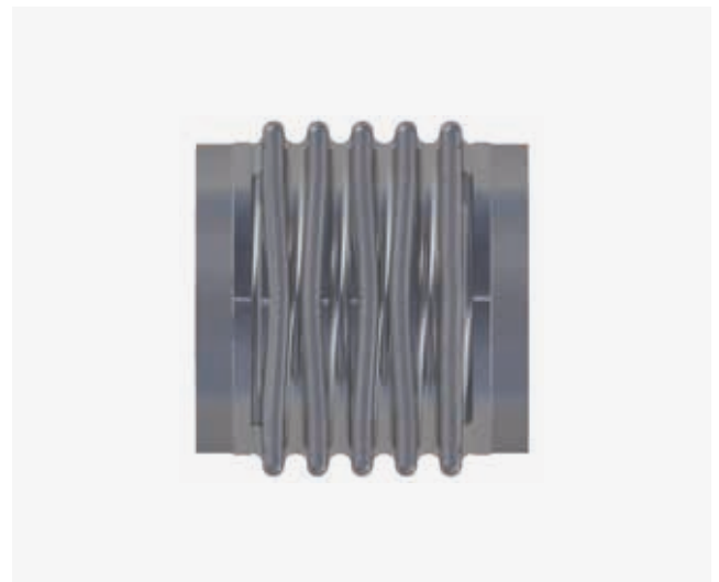
Welleninstabilität eines Stahlkompensators
