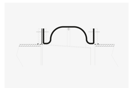
Einwellig mit Leitrohr, Vakuumstützring und Flanschen
