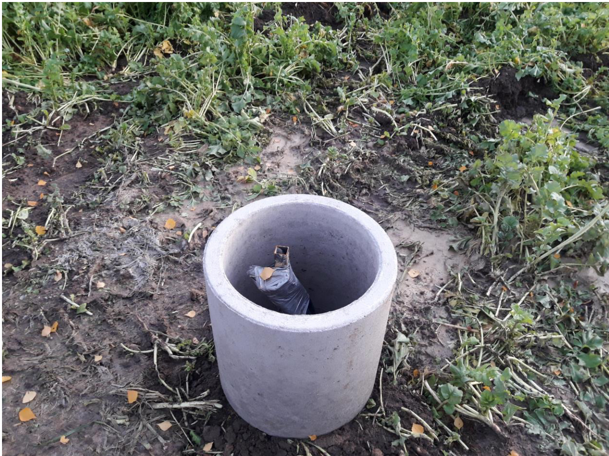
Abb. 1: Erdwärmesonde vor Testarbeiten
