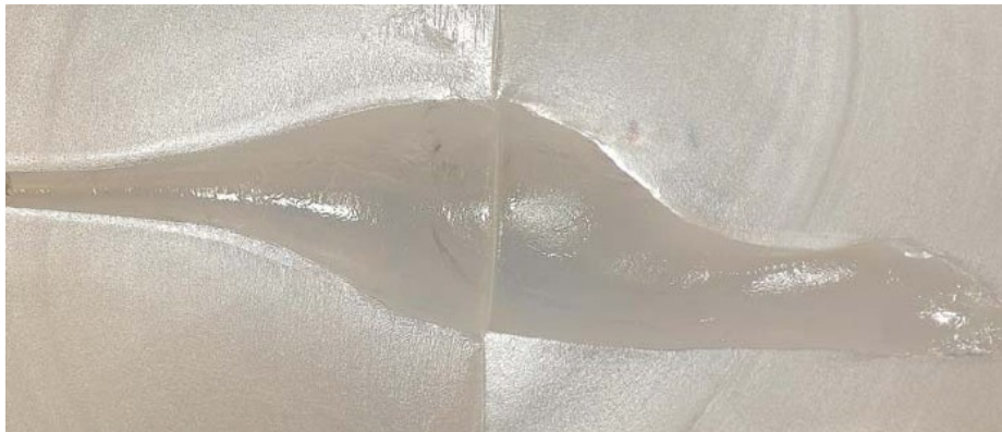
Abbildung 3: Schusskanal in Seife, längs aufgetrennt. (Quelle: DEVA e. V.)
