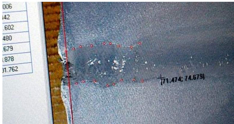
Abbildung 4: Vermessung des Schusskanals am PC von skaliertem Photographie
