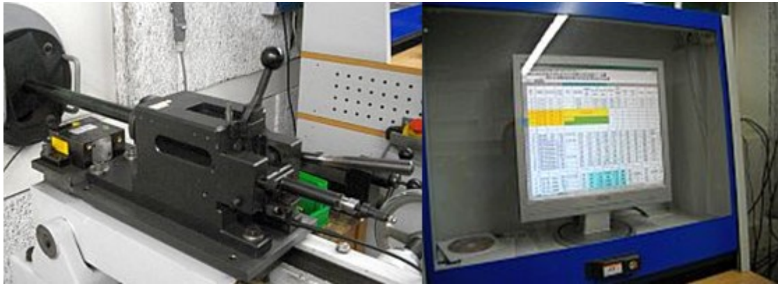
Abbildung 6: Schiessmaschine der DEVA e.V mit Datenerfassung
