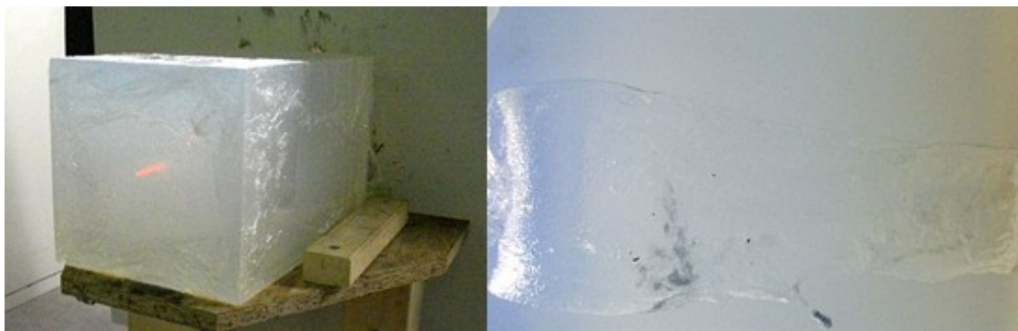
Abbildung 7: Seifenblock im Versuchsaufbau vor Beschuss und nach Beschuss im Schnittbild
