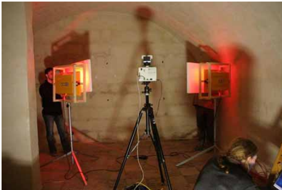
Abb. 153 Aufbau des Versuches an der Probenwand in der Fürstengruft (abgedeckter Zustand)
