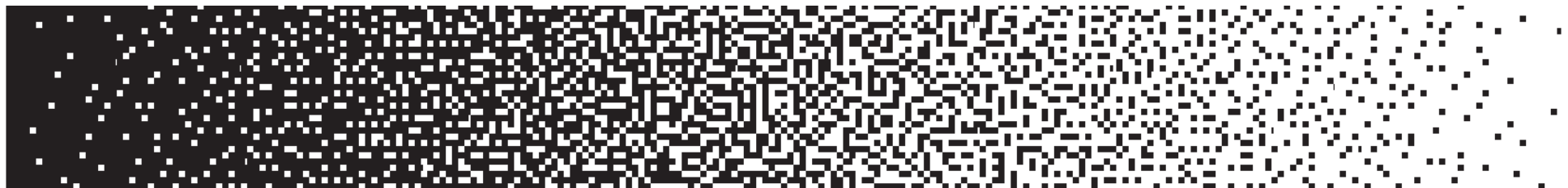
Abbildung 68: Diamond Screening (vergrößert).
