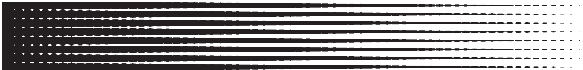
Abbildung 66: Punktform Megadot für die Farben Cyan, Magenta und Gelb (vergrößert).
