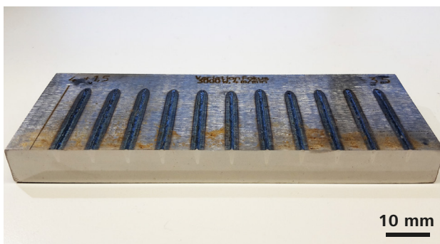
Abbildung 3: Makroskopische Ansicht der Probe nach erfolgter Schliffpräparation. Oben erkennbar die Schweißnähte in der Aufsicht, stirnseitig die geschliffene Fläche für die mikroskopische Betrachtung der Schweißnahtgeometrie mit dem ZEISS Smartzoom 5 (Nahtüberhöhung, Einschweißtiefe und Nahtbreite)
