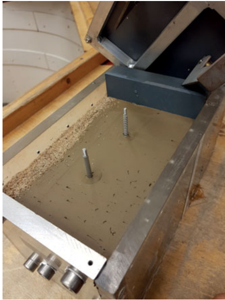
Modellaufbau: Tonmodell L x B ca. 200 x 150 mm; Modelltiefe 120 mm; Pfahl-Aussendurchmesser Schraubpfahl 5,5 mm, glatter Pfahl 5,5 mm; Pfahllänge 90 mm. Foto HSLU, Horw / TU Delft
