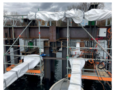
Stahlkonstruktion mit Press- und Messvorrichtungen für statische Pfahlbelastungsversuche der Schraubpfähle, Probepfählung ZüriBahn. Foto: EBP Schweiz AG, Zürich
