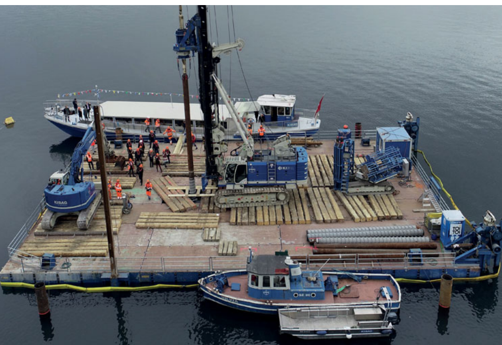
Stahlkonstruktion mit Press- und Messvorrichtungen für statische Pfahlbelastungsversuche der Schraubpfähle, Probepfählung ZüriBahn. Foto: EBP Schweiz AG, Zürich
