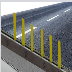
Schnittbild Hindernis im Fundament
