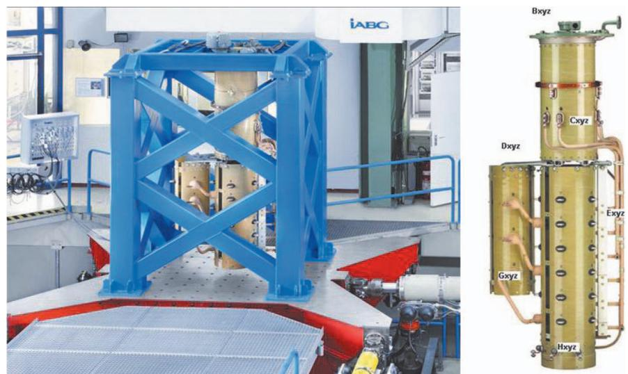
Bild 7. Hydraulischer Mehrachsenschwingtisch „HyMAS“ und Stufenschalter mit Messpositionen
