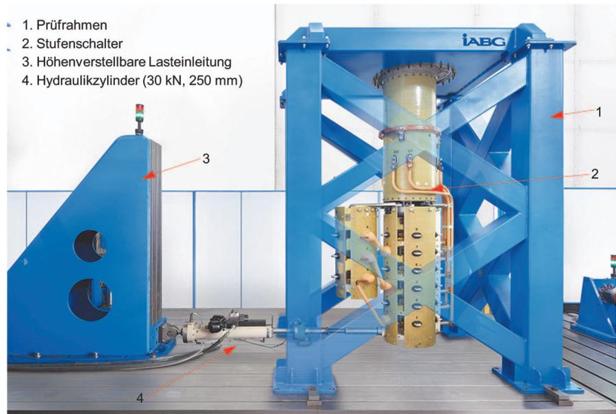
Bild 4. Prüfraumen mit Prüfling im Static-Load-Test
