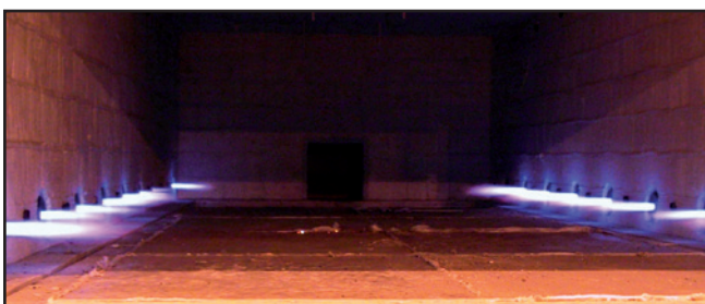
Rekuperatorbrenner an einem Herdwagenofen Recuperative burner on a bogie hearth furnace
