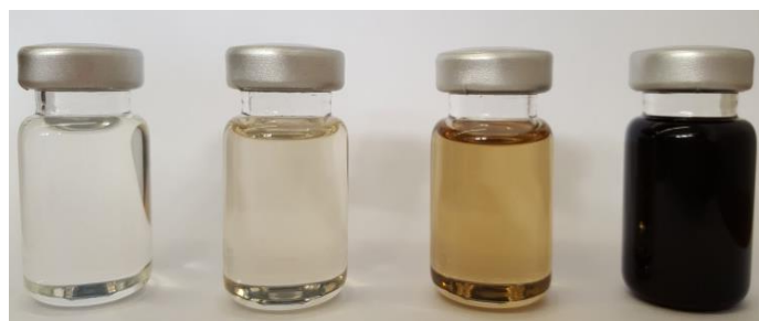
Bild 1: Mineralöl, Nanofluid A, Nanofluid B, Nanofluid C (von links nach rechts mit erhöhter Konzentration)
