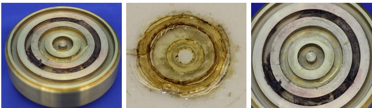
Bild 4: Feste Alterungsprodukte aus der Esterflüssigkeit Midel 7131
