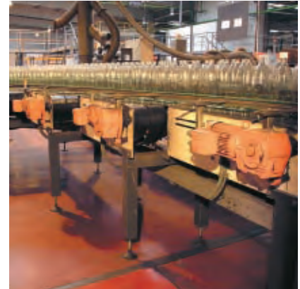
Ansteuerung von SEW-Antrieben über das AS-Interface.
