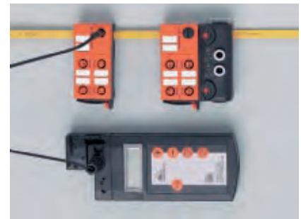
Mit dem Adressiergerät lassen sich die Slaves einfach per Kabel adressieren.
