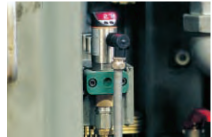
Analogwert- erfassung eines Systemdrucks.
