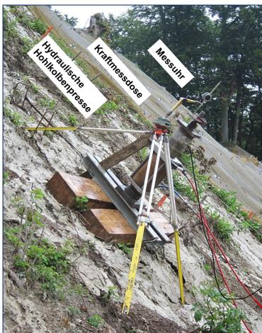
Prüfung der Kraftübertragung in den Baugrund durch Probelastungen
