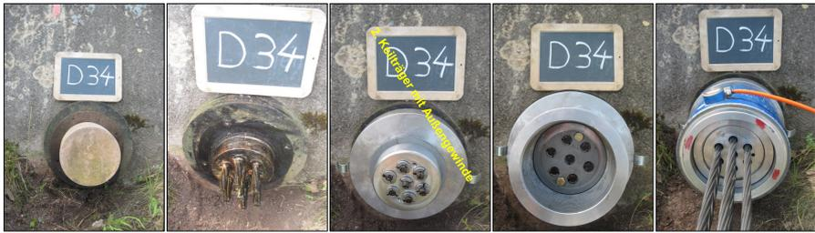
**Abhebeversuch an Litzenanker mit Keilträger ohne Außengewinde**
