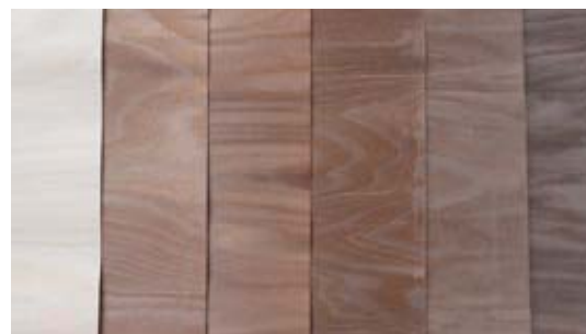
Abb. 1: Natives Furnier (links) und thermisch behandelte Furniere im Vergleich; zunehmende Behandlungsintensität von links nach rechts (Foto: IHD)
