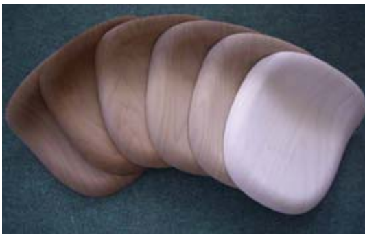
Abb. 2: Sitzschale „Gubi barstool“ (Reholz®), von rechts nach links: nativ, 170 °C, 175 °C, 180 °C, 185 °C, OWI) (Foto: IHD)
