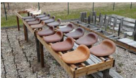
Abb. 4: Freibewitterungsstand mit Sitzschalen „Gubi barstool“ (Zustand im Einbau)
