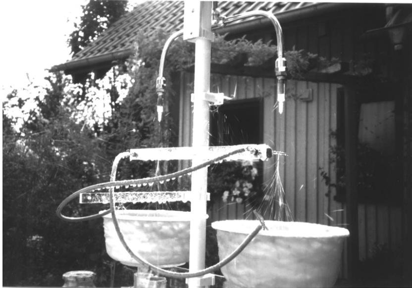
Bei eigenen Versuchen mit einer einfachen drucklosen Über-Kreuz-Anordnung wurden Spannungen von bis zu 15kV gemessen. Die Polarität der Aufladung scheint weitgehend dem Zufall überlassen, kann jedoch mit Hilfe einer definierten Vor-
