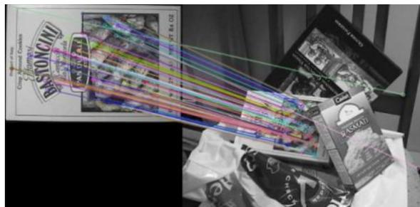
Abbildung 2.9: Feature-Matching mit SIFT-Detektor und SIFT-Deskriptor
