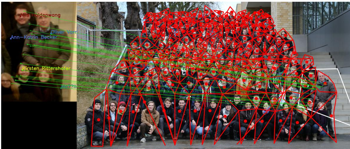
Abbildung 3.7: Als Beispiel das Algorithmenfoto 2015 (rechts), sowie das gewünschte Teilbild (links). Die hinterlegten Polygondaten (rot) sind mit ihrem Zentrum eingezeichnet. Aus dem Feature-Matching des ersten Schrittes (grün) kann die transformierte Region (weiß) gefunden werden.
