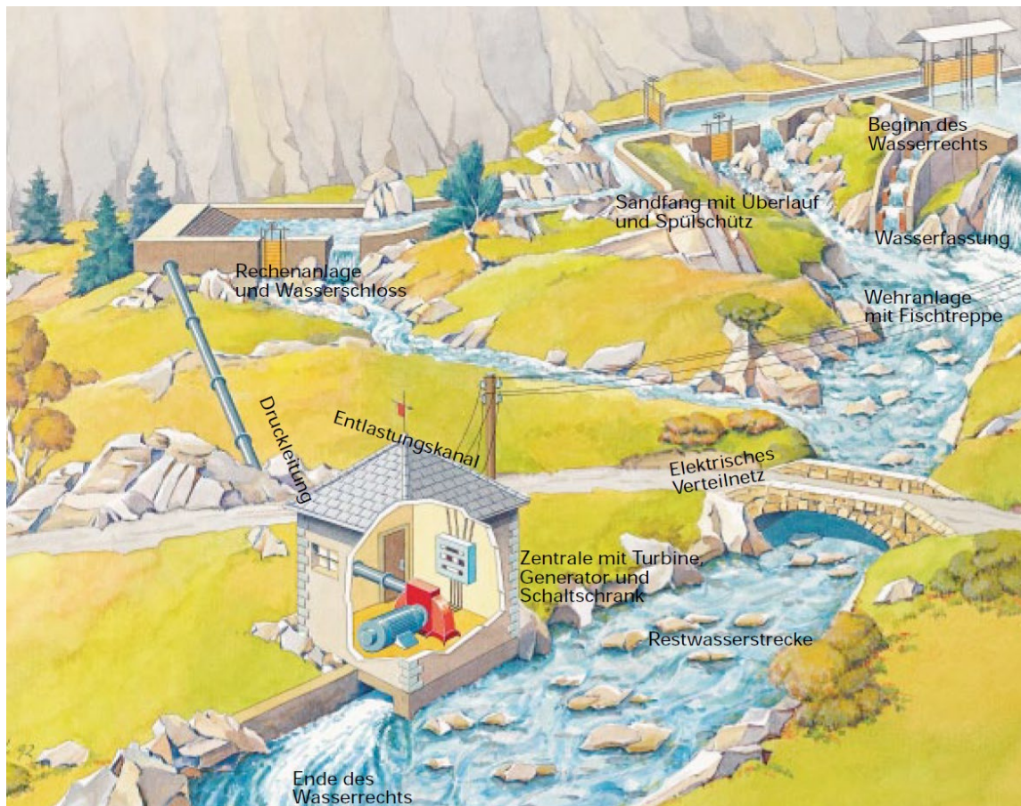
Abbildung 2-1 Allgemeine Anordnung eines Kleinwasserkraftwerkes, [3]
