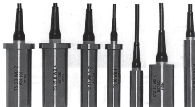
Abb. 2.22 Typen handelsüblicher Tauchtechnikprüfköpfe [2.10]
