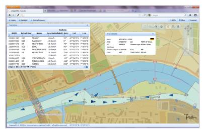
Parallel zur Anzeige in der Revierzentrale werden die AIS-Daten auch auf einem Webserver zur Verfügung gestellt, auf den dann von extern über einen Webbrowser zugegriffen werden kann.
