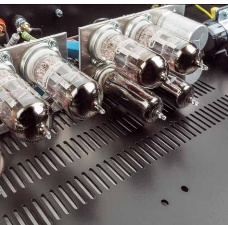
Die vier Röhren rechts bilden eine kanalgetrennte Spannungsregelung
