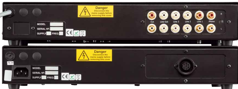
Oben: Etwas mysteriös bleibt der Einsatz zweier verschiedener Cinchbuchsen bei der Line-Vorstufe. Links: Nur eine der fünf Röhren in der Micro 25 RSL dient der Verstärkung
