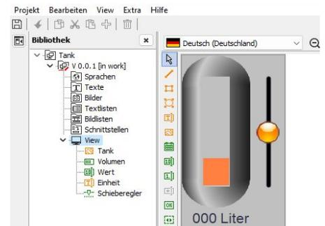
In der Ressource „View“ wird der Bildbaustein mit den bekannten VisuStage-Objekten erstellt (nicht alle sind für die Verwendung in einem Bildbaustein sinnvoll und deswegen ausgegraut) und bearbeitet. Die Konfiguration erfolgt in den üblichen Eigenschaftsfenstern wie bei der bisherigen VisuStage auch. Es können dabei jedoch keine Variablen zugewiesen werden (erfolgt in der Ressource Schnittstellen).
